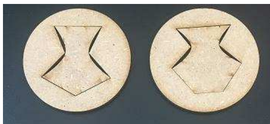
Fig. 4 : Deux exemples de cas d'encastrement erroné
